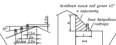
Вытяжной вентиляционный канал
